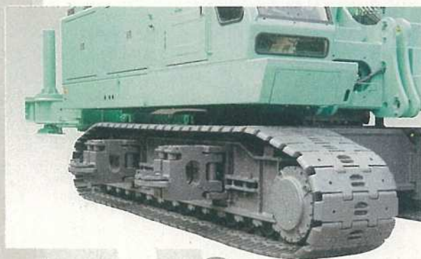
▲クローラ拡張作業中
