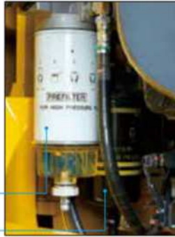
ウォーターセパレータ機能付 燃料プレフィルタ 高効率燃料フィルタ
